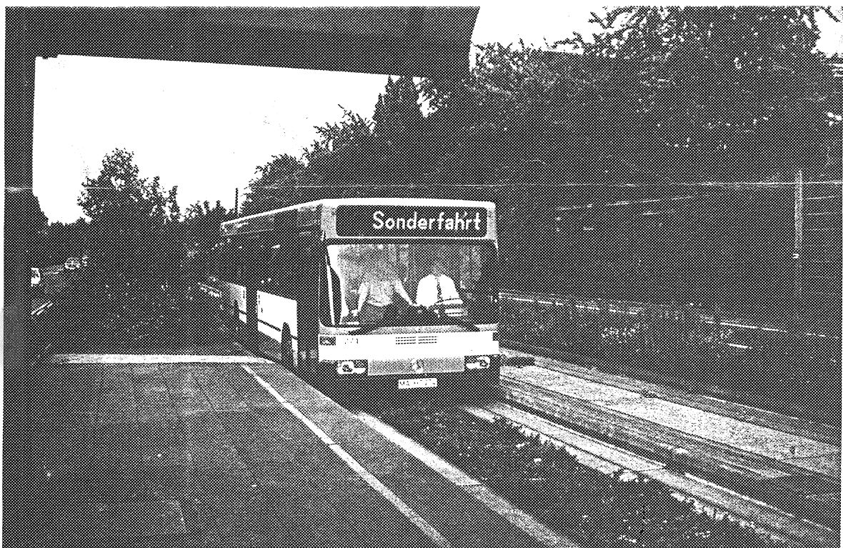
Niederflur-Spurbus 274 (Daimler-Benz O 405 N) der Mannheimer Verkehrs-AG (MVG) befährt die Spurbusstrecke auf dem Ruhr Schnellweg
