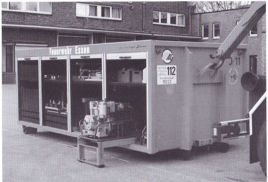
Oben: Magirus-Deutz Trägerfahrzeug der Berufsfeuerwehr Essen mit einem "Wechselaufbau EVAG" (WAB-EVAG).
